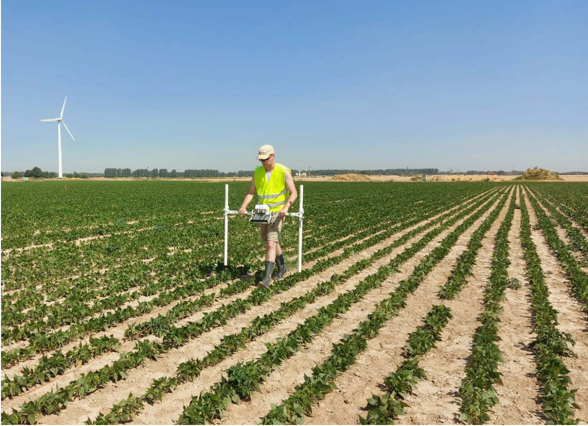
Abbildung 2: Geomagnetische Prospektion im Feld (Foto: Laura Gross)
