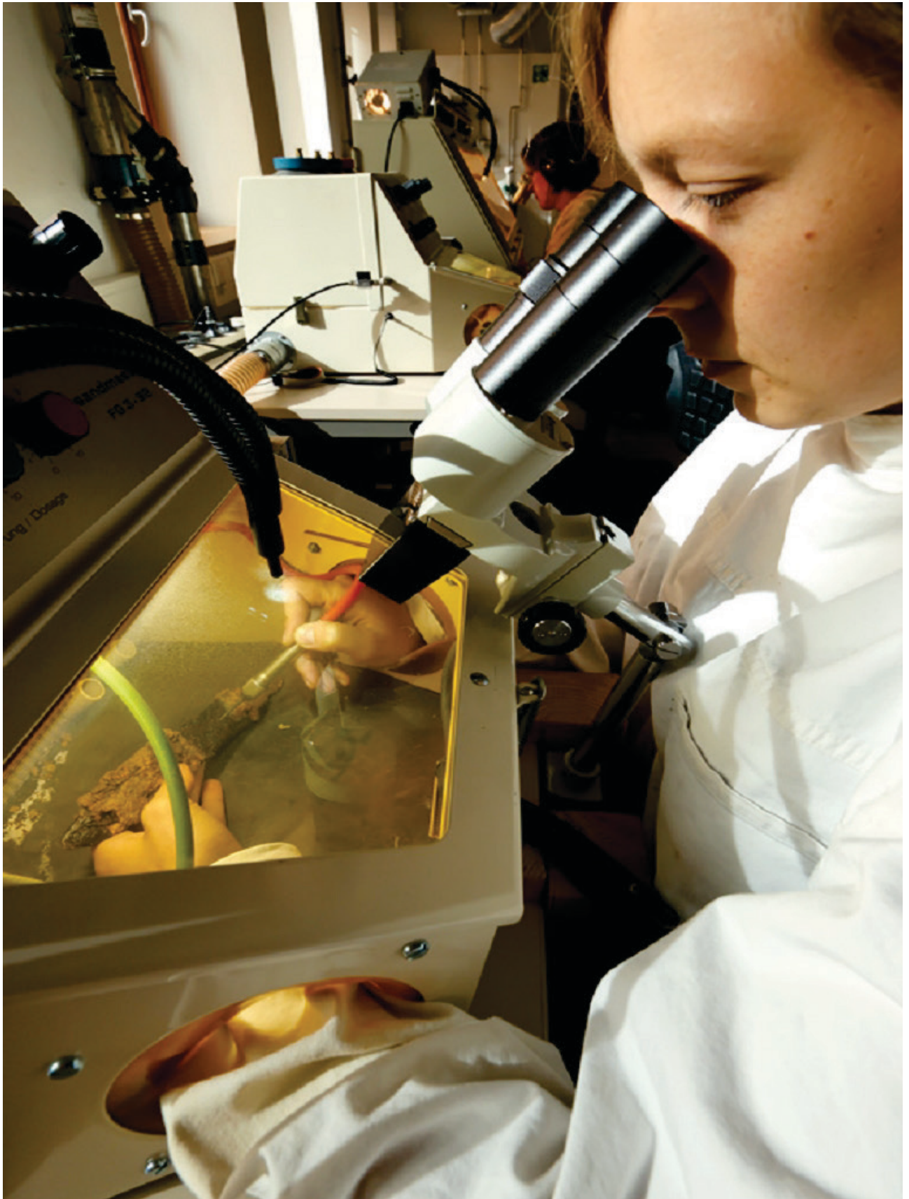
Abbildung 1: Freilegung von Eisenobjekten mit dem Mikrofeinstrahlgerät.
