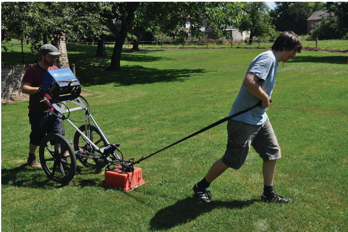
Abbildung 1. Georadarmessung bei Haus Paland mit den Mitarbeitern des LANU-Projekts Robin Peters (links) und Stefan Hartmann (rechts) (Foto: LANU).
